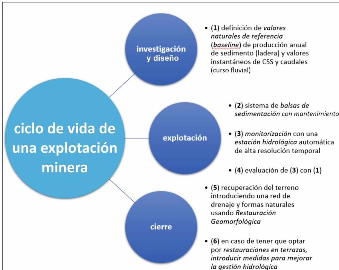
Figura 7. Esquema resumen de las mejores técnicas y medidas disponibles para gestionar el problema de la erosión hídrica e inestabilidad del terreno en una explotación minera, en base a las investigaciones llevadas a cabo en la zona minera de caolín del Alto Tajo.
