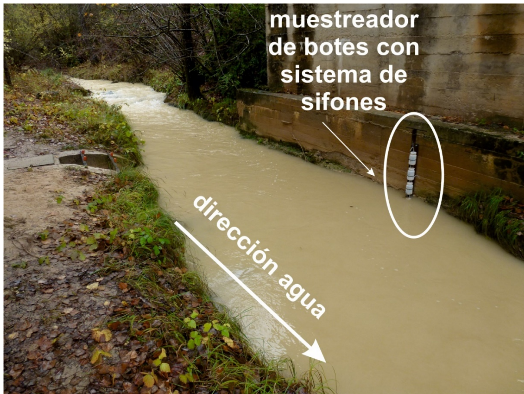
Figura 8. Vista de un muestreador automático no electrónico basado en botes sifonados localizados a diferentes alturas, llenándose durante una crecida en el río Tajuelo, afluente del Tajo.
