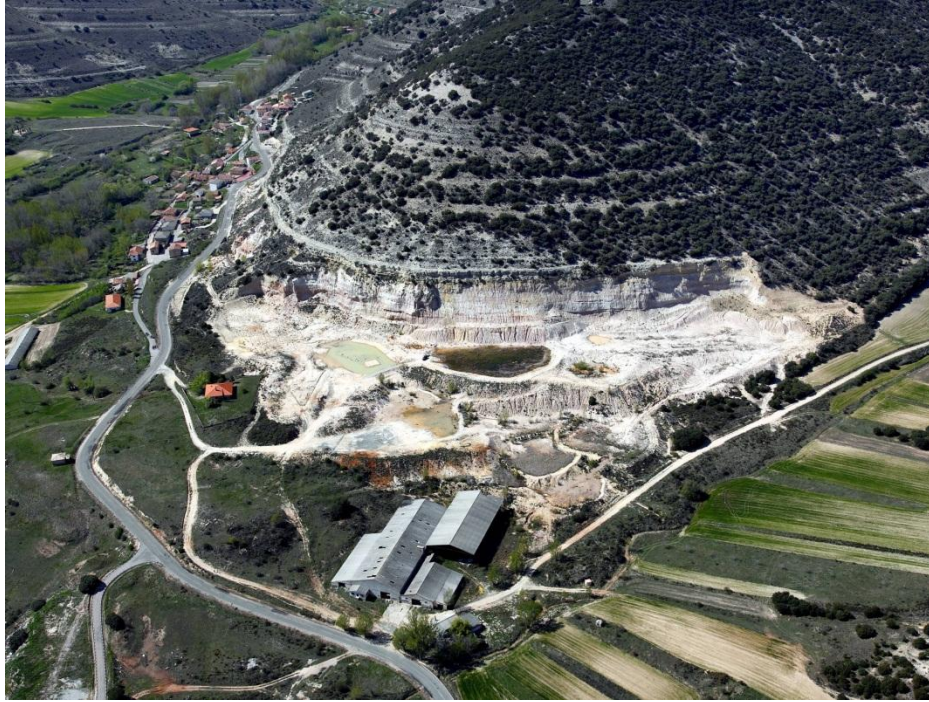
Figura 1. Punto de partida para el diseño de reconstrucción geomorfológica de una cantera en Somolinos (Guadalajara, España). Esta cantera constituye un ejemplo de pasivo ambiental, caracterizado por un remodelado en terrazas, muy inestable ante la erosión hídrica. Foto Paisajes Españoles.
