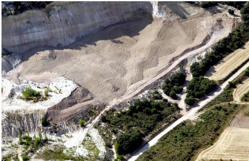
Figura 9. Superior, sector norte de la cantera de Somolinos antes de su reconstrucción geomorfológica (fotografía aérea oblica de Paisajes Españoles S.A., abril de 2011); (centro) vista 3D del diseño de este sector; (inferior) sector norte de la cantera de Somolinos después de su reconstrucción topográfica, incluido el extendido de un coluvión carbonático que actúa como protosuelo (fotografía aérea oblica de Paisajes Españoles S.A., julio de 2011).
