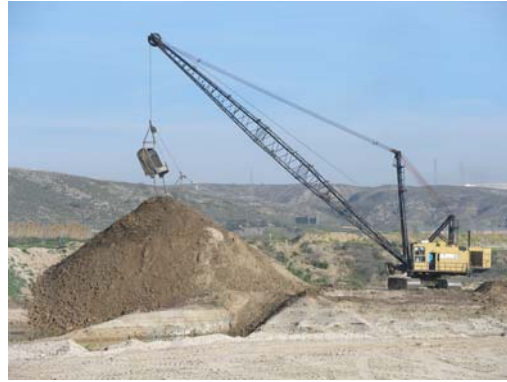
A la izquierda: hueco de explotación. A la derecha: dragalina en operación.
